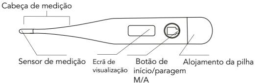
Este termómetro digital de ponta flexível, muito fiável e simples de utilizar, permite medir a temperatura do seu bebé com um resultado instantâneo: 9 a 11 segundos em modo rectal.
